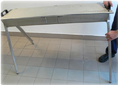
d. Öffnen Sie den Deckel der Maschine und stabilisieren Sie ihn mit den Rückbeinen.
