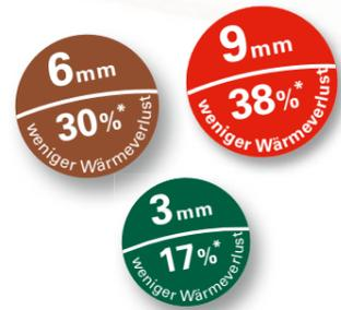
Durch die besonderen Materialeigenschaften ergeben sich attraktive Reduktionen des Wärmeverlustes (im Verhältnis zu einem ungedämmten 24 cm starken Ziegelmauerwerk).
